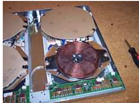
Interno di un piano cottura a induzione, con una delle 4 bobine in vista
