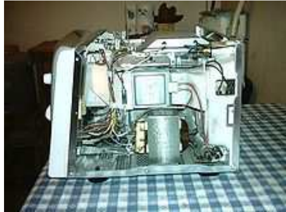
Forno a microonde aperto: si vede il trasformatore in basso ed il magnetron (coperto da una calotta metallica) immediatamente sopra
